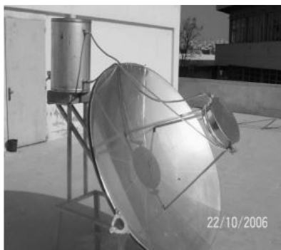
FIGURE 5.18 – Le concentrateur en mode chauffe-eau [31]
