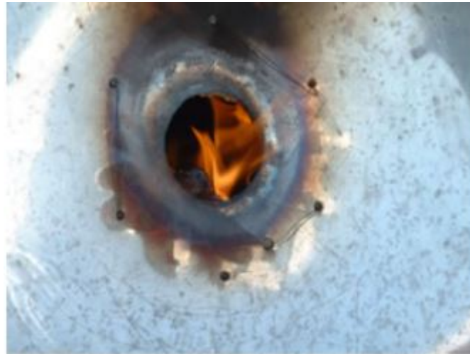
FIGURE 6.14 – Entrée de la chambre de combustion [32]
