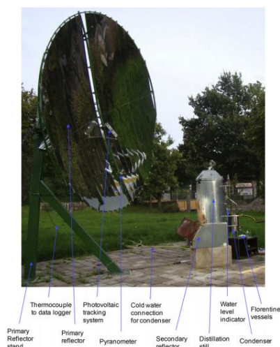
FIGURE 6.5 – Photo du système de distillation solaire [35]
