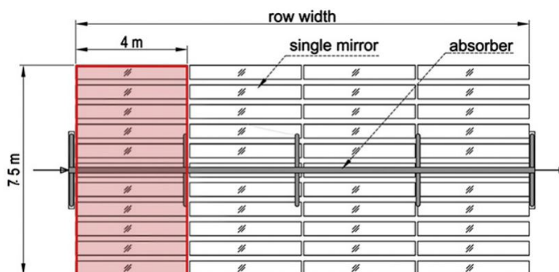
FIGURE 3.15 – Dimension des collecteurs LFR [15]
