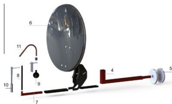
FIGURE 5.10 – Détails du concentrateur solaire [28]
