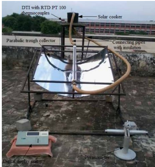
FIGURE 2.10 – Photo du système testé [6]
