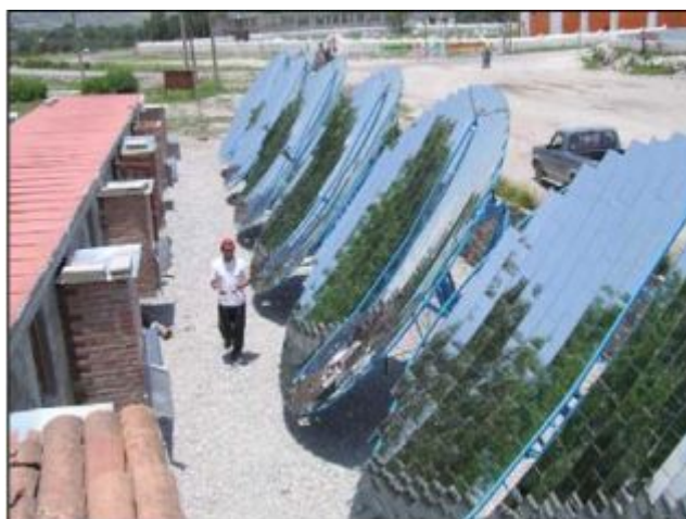
FIGURE 6.12 – Scheffler de 10m^2 utilisés pour la production de sirop d’agave [37]
