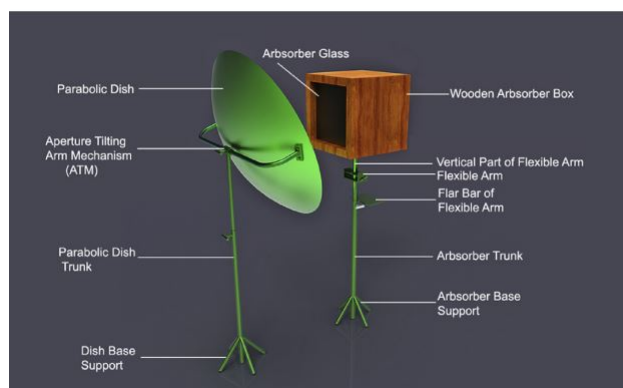
FIGURE 5.4 – Représentation 3D du concentrateur et la boîte [25]
