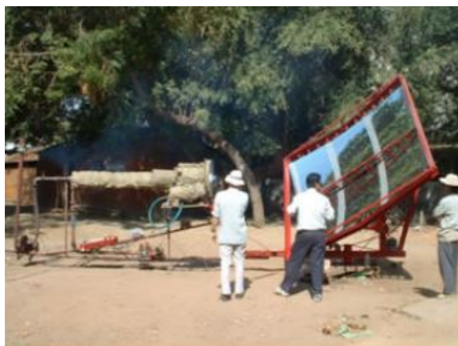
FIGURE 6.13 – Photo du four crématoire solaire miniaturisé [32]
