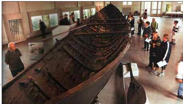
(gauche) Principe de la construction à clins. (droite) Drakkar (bateau de Nydam), 23 m, 3 tonnes, +300. Premier exemple de construction à clins.
