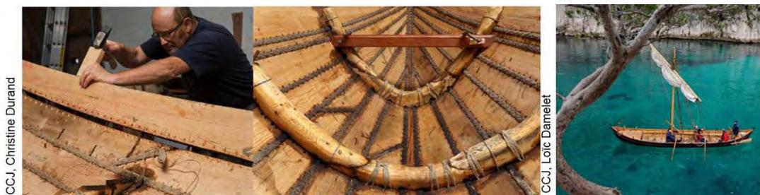
*Reconstruction d'une barque grecque cousue, -500. La construction nécessite 5 km de fil de lin et 10000 chevilles. L'étanchéité se fait à l'aide de cire d'abeille et de poix. Aucun clou ou vis n'est utilisé.*
