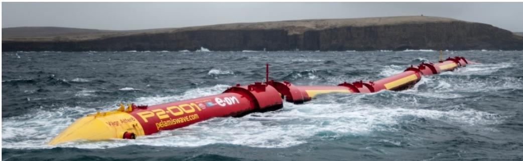
FIGURE 5.10 – Pelamis, le "serpent de mer", exploite les oscillations verticales et horizontales engendrées par les vagues sur les articulations entre des bouées cylindriques. (Source : European Marine Energy Centre)
