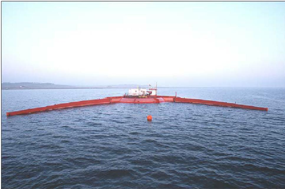
FIGURE 5.16 – Photographie du prototype de *Wave dragon* au large du Pays de Galles. On y observe deux grandes ailes réfléchissantes et au centre le réservoir. Source :wavedragon.co.uk
