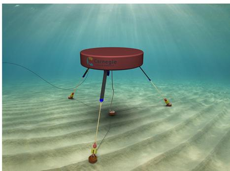
FIGURE 5.5 – Modèle de la technologie CETO 6. Source : carnegiece.com.
